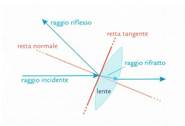
Per studiare il passaggio della luce attraverso una lente è necessario conoscere l'angolo di incidenza (ossia l'angolo con cui il raggio incidente colpisce la superficie della lente) per poter poi applicare le leggi di rifrazione per determinare l'angolo di rifrazione (ossia l'angolo che il raggio rifratto forma con la superficie della
