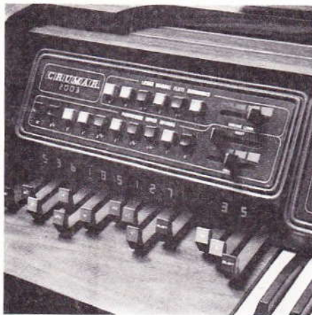
Fig. 28. I controlli estraibili (o drawbars ) permettono di regolare l'intensità dei suoni sinusoidali emessi. Le cifre sopra i drawbars indicano appunto le intensità predisposte.
