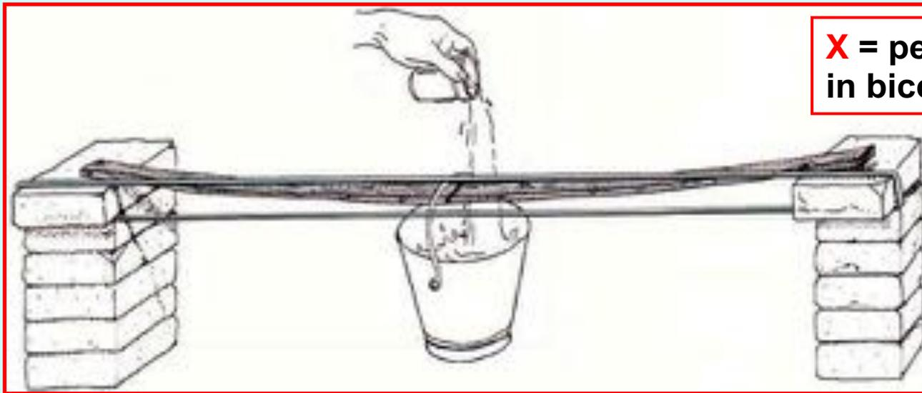
**Y** = deformazione della trave, misurata con la lunghezza di  $f$
